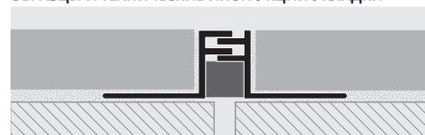
1. Выберите высоту PROFLEX ALN, равной с толщиной пола (кафельной плитки), также выбирая цвет вкладки.
