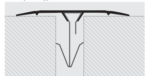
**PROPLATE FIX** - серия покрывающих профилей для покрытия структурных перемещений и растяжения (усадка изгиб - усадка сжатие) двух различных несущих структур.
