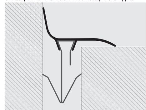
1. Выберите профиль с требуемой шириной и материалом. 2. Введите крепежные зажимы в подходящую выемку, каждая размером 50/75 см (5 шт. для применения на стенах - 10 шт. для применения на полу). 3. Введите/положите PROPLATE FIX в имеющийся пустой проем, применяя всестороннее давление или используя правильный капроновый молоток, таким образом создавая идеальное покрытие шва. Такой же метод используется для укладки углового профиля.
