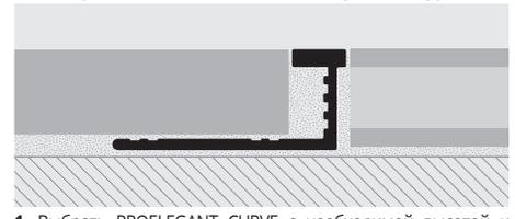
1. Выбрать PROELEGANT CURVE с необходимой высотой и материалом. 2. Порезать профиль до необходимой длины, учитывая общую длину. 3. Согнуть профиль механически с помощью PROCURVE MACHINE. 4. В случае необходимости зафиксировать винтами и якорями винта или просто вставить перфорированную основу под пол, уложенную тем же клеящим средством. Любые следы окисления могут быть легко удалены определенными химическими веществами (Сидол-Смак, и др.).
