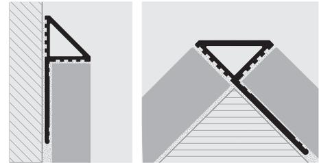
1. Выберите Projolly Triangle в желаемом варианте отделки и высотой, соответствующей толщине плитки.
