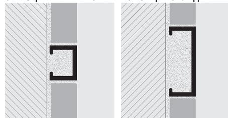
1. Выберите профиль с желаемой отделкой. 2. Наносите клей на место укладки профиля. 3. Приложите и подравняйте отрезанный по размеру профиль. 4. Положите плитки или слой смолы так, чтобы верхний край профиля закрывал шов.
