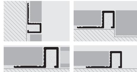
1. Выбирать "PROFINAL" с той же самой высотой как толщина облицовки стен/пола.
