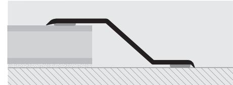
1. Выберите подходящий профиль и отрежьте его по необходимой длине. 2. Прочистите, промойте, обезжирьте твердую поверхность тщательно. 3. Удалите защитную пленку с клеящего средства. 4. Положите профиль правильно, применяя равномерное давление по всей поверхности, не используя молоток.
