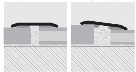
1. Выберите отделку PROCOVER 14PT и отрежьте его на нужную длину. 2. Обезжирьте, помойте и почистите твердую поверхность. 3. Снимите бумагу с клея. 4. Установите профиль, применяя равномерное давление без постукивания.
