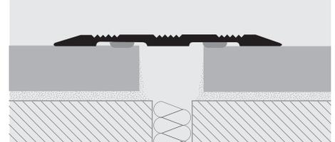
1. Выберите версию PROPLATE 80ALZ с клеем или без, отрежьте профиль на необходимую длину. 2. Обезжирьте, помойте и почистите твердую поверхность. 3а. Снимите защитную полосу бумаги с клея (адгезивная версия). 4а. Установите профиль, применяя равномерное давление без постукивания. 3б. Сделайте отверстия с одной стороны и вставьте в них дюбеля. 4б. Зафиксируйте профиль с помощью шурупов с плоской головкой.
