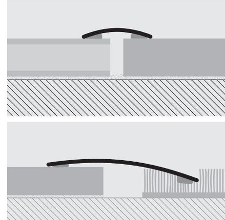
1. Выберите подходящий профиль и отрежьте его по необходимой длине. 2. Прочистите, промойте, обезжирьте твердую поверхность тщательно. 3. Удалите защитную пленку с клеящего средства. 4. Положите профиль правильно, применяя равномерное давление по всей поверхности, не используя молоток.
